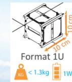
**1<sup>U</sup>** nanosatellite 1Unité (ou CubeSat 1U) : cube de 10 cm d'arête . 1 kg . 1 Litre
